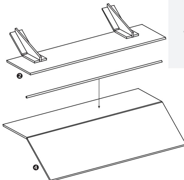
Assemble **2 moitiés de toit** selon le schéma, avec les **2 biais de charpente** et les **8 petites pièces de bois (50 / 10 / 2,4 mm)** avec de la colle à bois. Colle ensuite la **tige ronde dans l'encoche** entre les 2 moitiés de toit. Le toit peut être collé plus facilement en collant au préalable les petites pièces en bois (comme indiqué sur le schéma) puis en forçant délicatement la deuxième moitié du toit.
