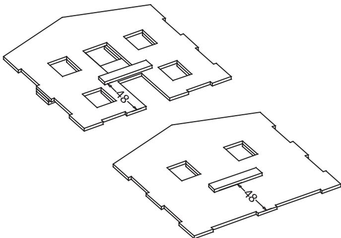
Colle sur les **murs avant et arrière** de la maison une **latte (50 / 10 / 2,4 mm)** comme support du plancher intermédiaire en polystyrène.
